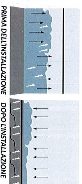
Dallo schema possiamo vedere come **PRIMA** dell'installazione del dispositivo la parete sia interessata da correnti vaganti che causano la risalita dell'umidità dal terreno.
